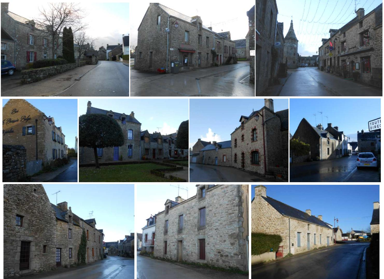
Les constructions présentent 2 (RC + combles) à 3 niveaux (RC+ 1 étage + combles), elles sont établies en moellons avec des entourages en granite autour des fenêtres et des portes (plus rarement avec des briques). Les ouvertures des façades présentent généralement une organisation respectant une certaine symétrie. Des lucarnes éclairent généralement les combles. Les constructions sont recouvertes de toitures à pans en ardoises.
