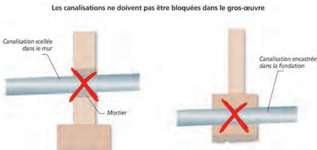
**Conditions de mise en œuvre :** Les canalisations seront réalisées avec des matériaux non fragiles (c'est-à-dire susceptibles de subir des déformations sans rupture). Elles seront aussi flexibles que possibles, de façon à supporter sans dommage les mouvements du sol.
