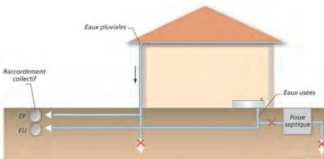
**Conditions de mise en œuvre :** Le raccordement au réseau collectif doit être privilégié, sans préjudice des directives sanitaires en vigueur.
